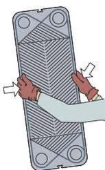
Abra o conjunto de placas deixando a placa de pressão deslizar sobre a barra transportadora.
