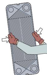
Откройте набор пластин, сдвинув прижимную пластину по несущему стержню.
