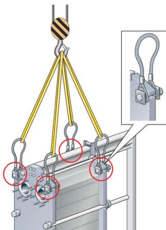
**Рис. 4: Подъемное устройство для AQ14 и AQ14S. Требуется крепежное оборудование.**
