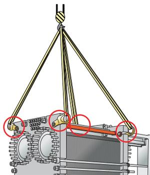
Рис. 6: Подъемное устройство для AQ20. Требуется крепежное оборудование.
