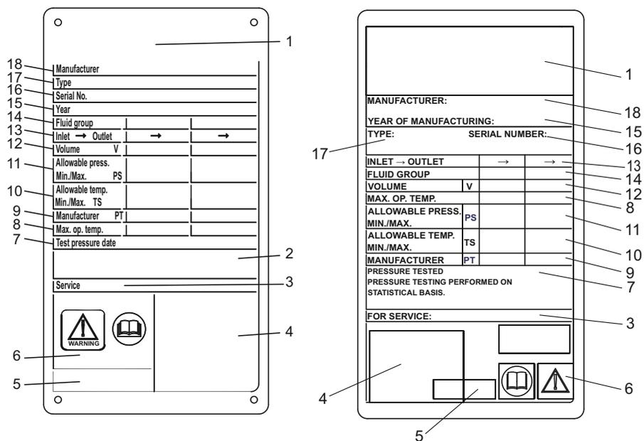
Рис. 1: Пример металлической паспортной таблички CE слева и паспортной таблички в виде наклейки CE справа
