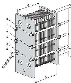
Ослабьте четыре стяжных болта (1), (2), (3), (4) или шесть стяжных болтов (1), (2), (3), (4), (5), (6) по диагонали так, чтобы расстояние **A** набора пластин составляло 1,05, при этом во время открывания опорная и прижимная пластины должны располагаться параллельно. Продолжайте выполнять эти действия для каждого болта до тех пор, пока все прижимные усилия, действующие на набор пластин, не будут устранены. Затем снимите болты.
