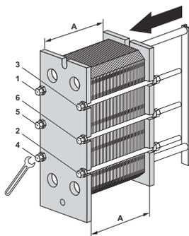
**7** Равномерно затяните четыре болта (1), (2), (3), (4) или шесть болтов (1), (2), (3), (4), (5), (6) так, чтобы было установлено соответствующее расстояние **A**.
