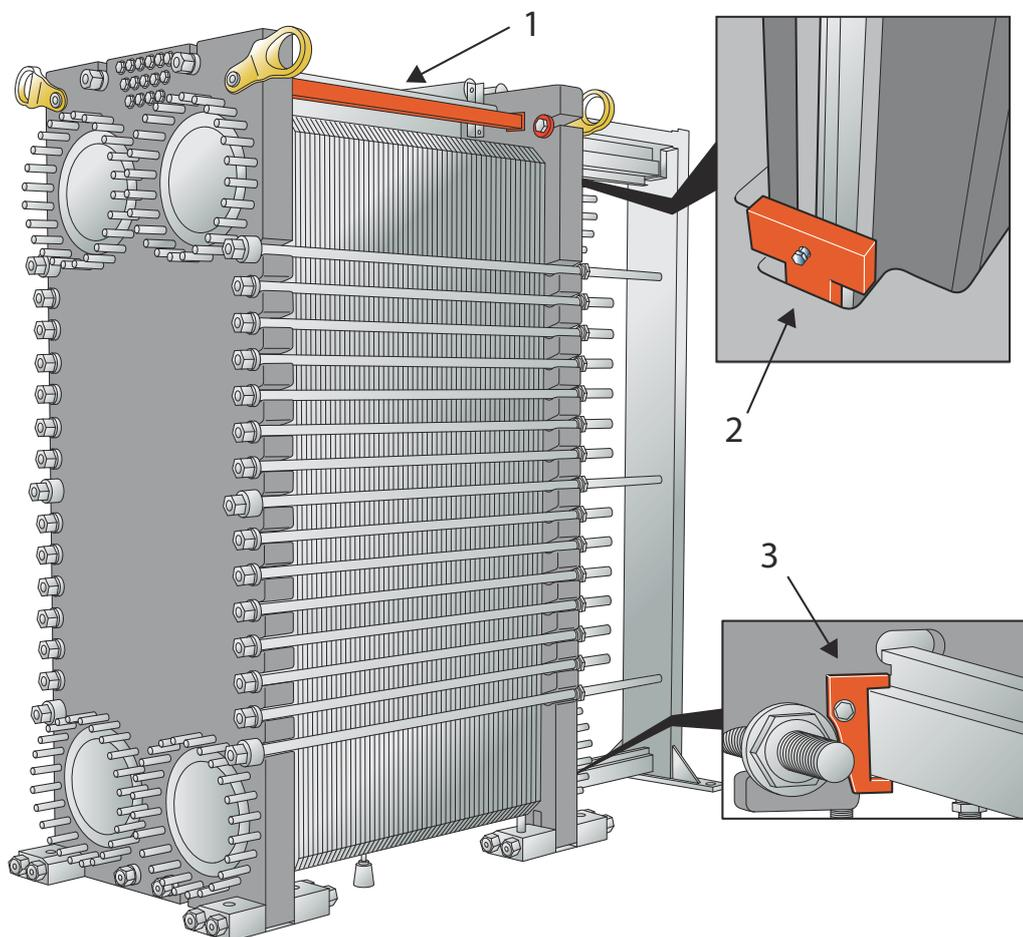
1. Надежно закрепите устройство блокировки между опорным и прижимной пластиной.
