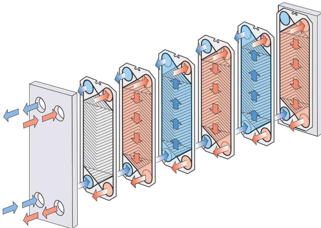
Рис. 2: Пример одноходовой конфигурации.
